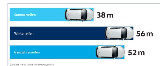
Bremswegvergleich von Sommer-, Winterund Ganzjahresreifen auf trockener Fahrbahn aus 100 km/h bei ca. 20°C
